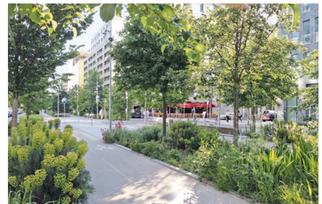
Oben: Leicht vertiefte Grünstreifen mit Bäumen und Stauden trennen Fahrbahnen und Trottoirs und nehmen Regenwasser auf. Bild und Plan: Agence Laverne
